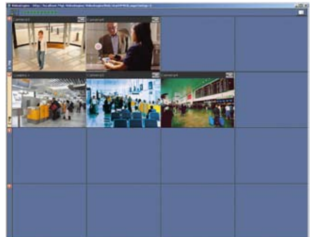
Exemplo de uma matriz de alarme com duas situações de alarme ativas.
